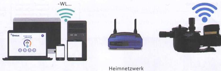
Die EPV-Pumpe mit variabler Geschwindigkeit und Wi-Fi kann so eingestellt werden, dass sie sich mit dem Heimnetzwerk verbindet, um die Reichweite zu erhöhen und den Zugang zu erleichtern.
